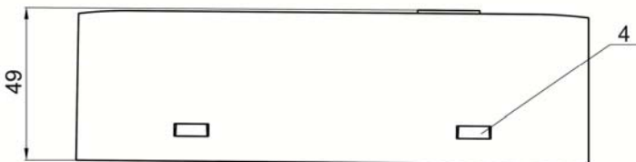
Рисунок А2. Габаритные и установочные размеры прибора ВЭРС-ПК1(ТМ)-01 Версия 3.2.
