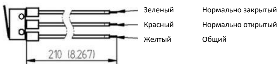
Изображение 4.21 Схема подключения блокировочного микропереключателя
