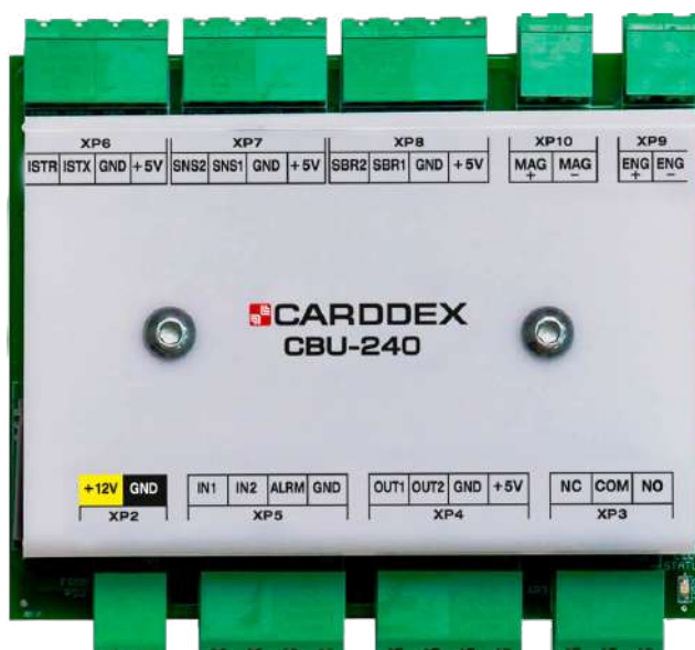
Рисунок 6.3.1 Контроллер управления турникетом «CBU-240»
