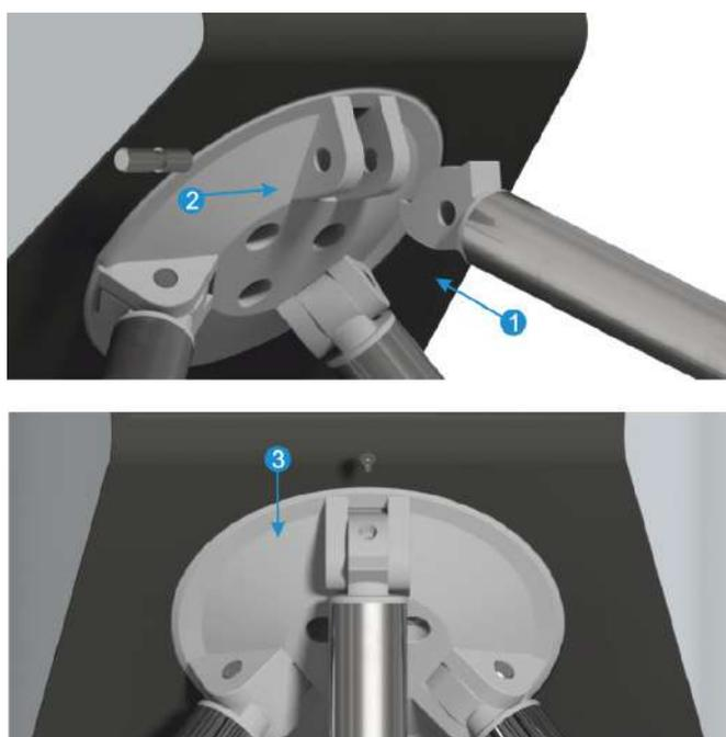
Рисунок 7.5.1 Установка преграждающих планок
