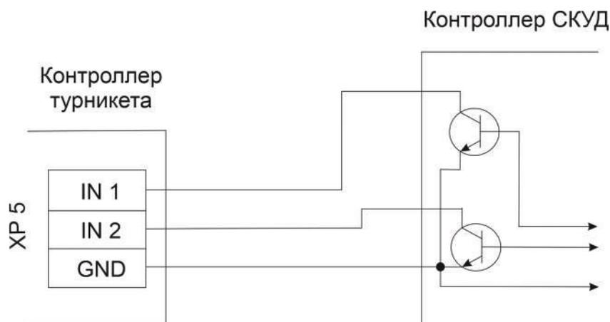
Рисунок 8.2.2 Схема подключения турникета к СКУД «открытый коллектор»
