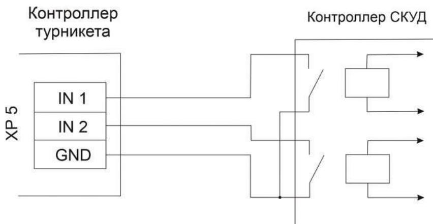
Рисунок 8.2.2 Схема подключения турникета к СКУД «сухой контакт»
