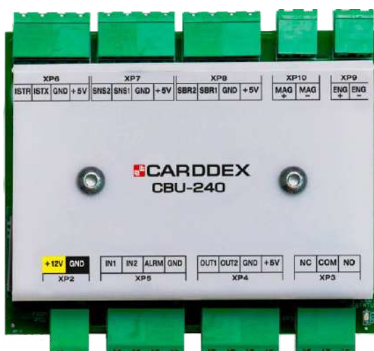
Рисунок 6.3.1 Контроллер управления турникетом «CBU-240»
