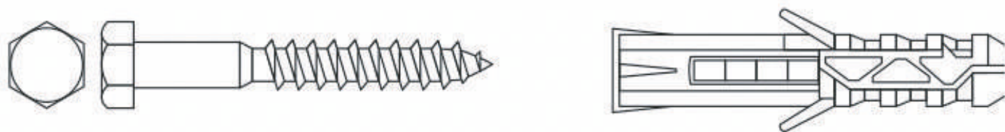
Рисунок 7.4.1 - Шуруп с шестигранной головкой «Глухарь» с дюбелем
