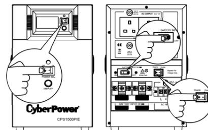
Выключатель питания, переключатель выхода и аккумуляторная батарея SW перед установкой должны быть выключены.
