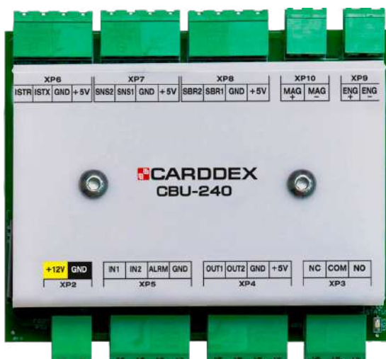
Рисунок 6.3.1 Контроллер управления турникетом «CBU-240»
