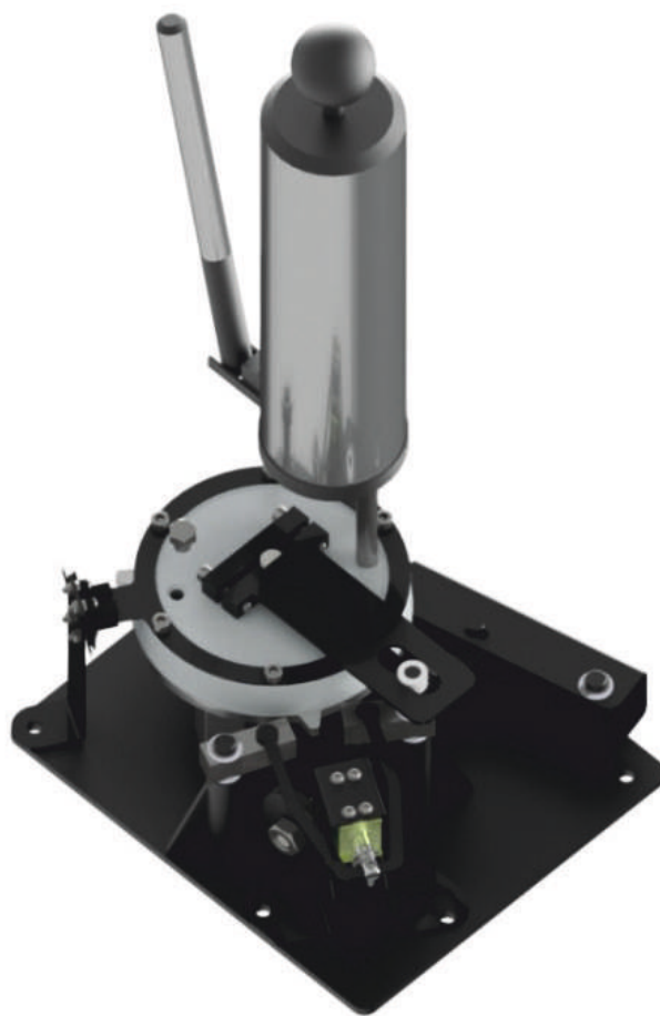
Рисунок 12.3.3 - Доливка демпферной жидкости.
