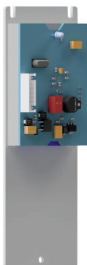
Рисунок 6.3.2 Внешний вид бесконтактного считывателя карт формата Mifare
